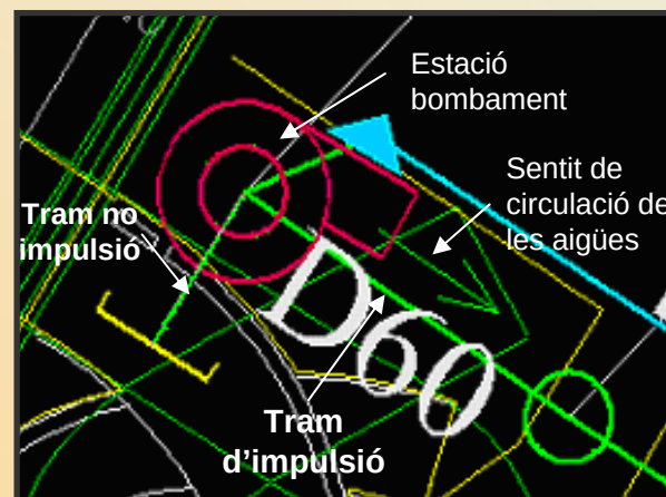
Exemple tram circulació per impulsio (SIG CLABSA)
