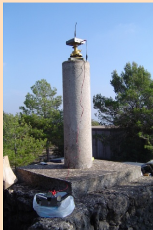
Estació de mesura GPS
